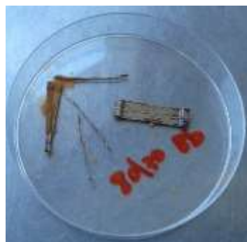
Fibre corrodibili, prova non superata
