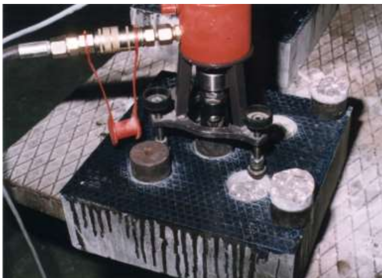
Esecuzione del test secondo UNI EN 1542
